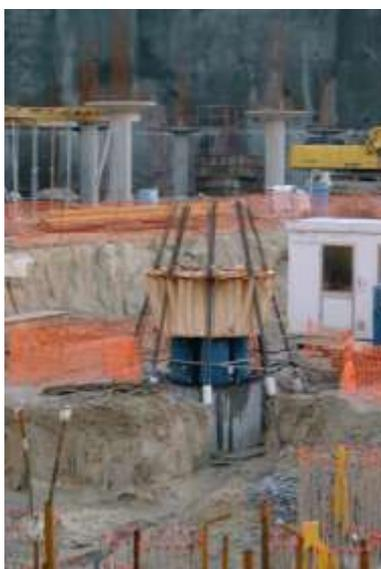
Realizaram-se 2 ensaios de carga em estacas. O primeiro tinha como fim a avaliação da carga última das estacas. (2 x carga de serviço numa estaca Ø800). Com o segundo pretendia-se avaliar o seu comportamento em serviço (1.5 x carga de serviço numa estaca Ø1300). Os resultados dos ensaios de carga confirmaram as condições de execução das estacas eram adequadas. Note-se que os ensaios de carga foram realizados já com a obra em andamento (não foram ensaios prévios).
